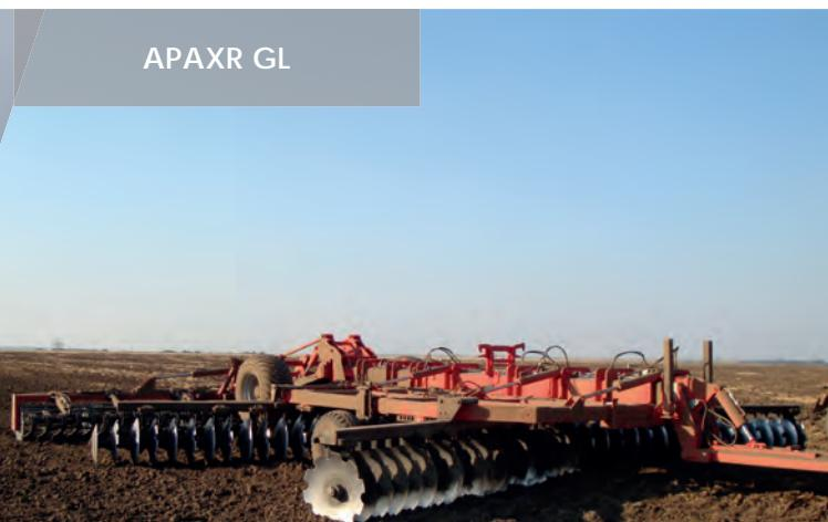
Disques crantés avant et lisses arrière + 2 oustridgers
