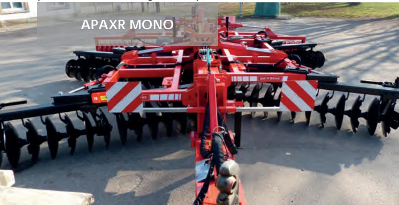
**APAXR MONO** : Flèche mécanique avec attelage sur bras de relevage
