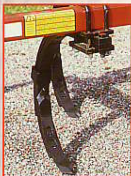
Dent bilames Doppelte Zinken Double tines
