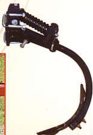
Dent bras carré de 38 Arms tines square of 38 Arm Zinken Welle 38
